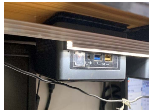
写真④各柱に設置しているインターフェース
