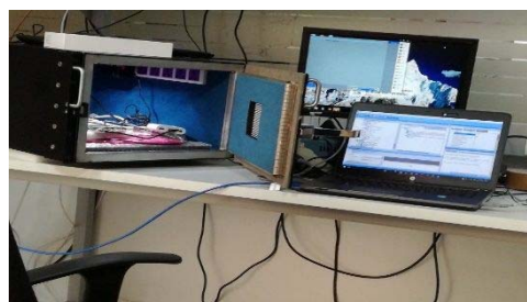
電波を遮断し、電波強度等を図る測定機器による端末のチェック
