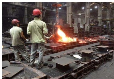
注湯作業の様子
