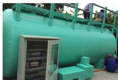
浄化槽(メーカー工場にて)
