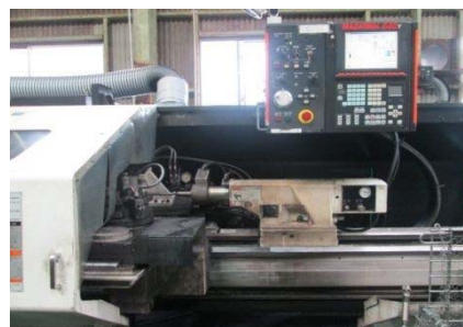
数値制御機械。ボルトの仕上げに使用される。ボルトを0.001mmの単位でカットすることができる。
