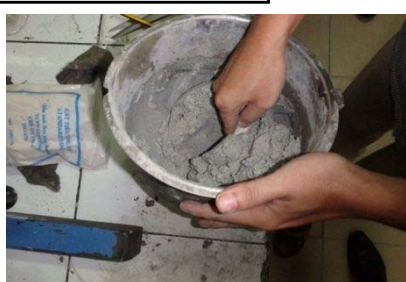
ISO 9597(JIS R5201) セメントの強さ試験業務
