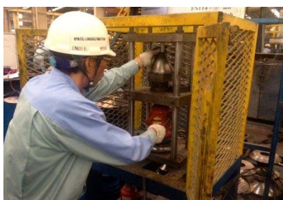
溶接強度の検査
