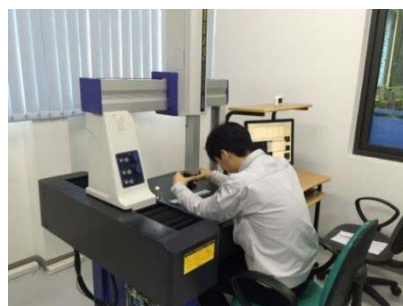
計測装置で部品寸法を測定
