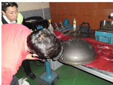
受入検査行程で磁粉探傷試験
