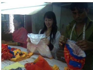
<OUT-PUT QC 作業>縫製ラインの最終検品工程にて、縫製に関する品質チェックを行う
