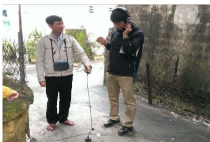
写真3 漏水箇所の調査
