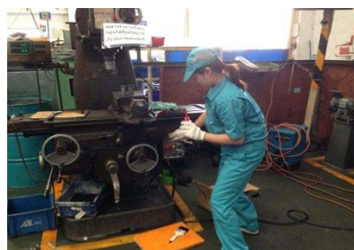
オーバーホール解体前清掃時
