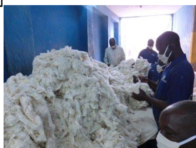
コンタミネーション除去作業
