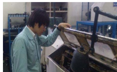
ダストカバー耐久試験の途中経過の確認
