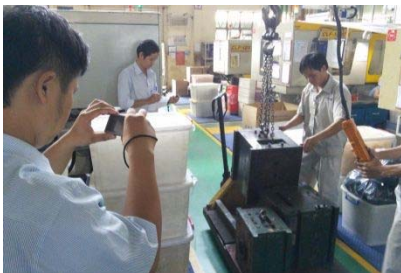
改善活動の一環で、金型交換作業の時間を測定している様子
