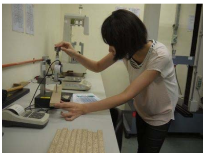
木材の力学特性試験に際し、厚さ測定を行っている様子
