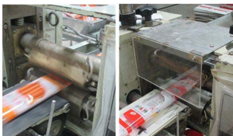
包装機のカット部にカバー設置(右:改善後)
