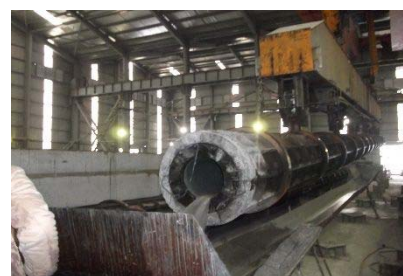
FECONのPHC杭製造工場
